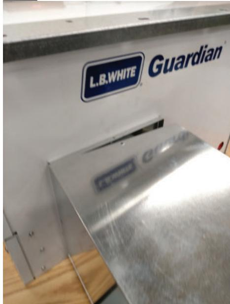
**Ensamblaje del deflector y de la malla para insectos al calefactor**
