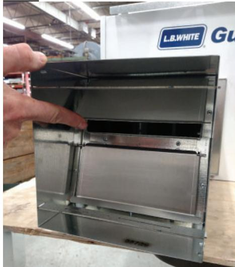
Ajuste el conducto externo al borde externo de la brida de extracción con 4 tornillos (artículo F). Vea la figura 11. Ajústelos bien.
