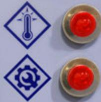
**Indicateurs de défaillance** Le voyant supérieur indique une condition de limite élevée, tandis que le voyant inférieur indique une défaillance de chauffage.
